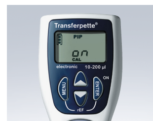
Justieren ohne Werkzeug mit der Easy Calibration-Technik
